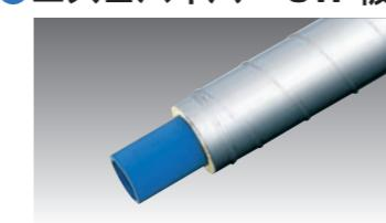
エスロハイパー JWを硬質ウレタンフォームで被覆し、スパイラルダクト直管(鋼管またはステンレス管)で外側保護したタイプです。金属管に比べ1/3~1/5と軽量で施工性に優れ、橋梁添架配管に最適です。
