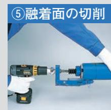
ペンでマーキングした部分及び標線が完全に消えるまで専用切削工具で切削してください。
