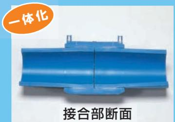
EF接合により一体化管路を構築。継手の抜けがありません。
