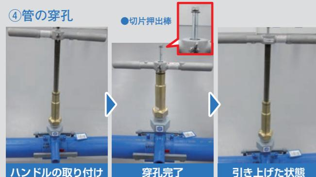
1) 穿孔機にハンドルを差し込み、蝶ネジで固定します。
