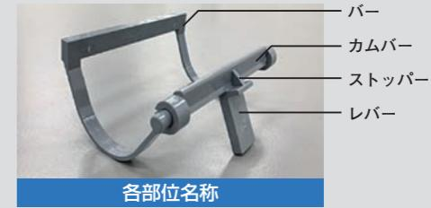
1) バーをサドル分岐側ツバにセットします。
